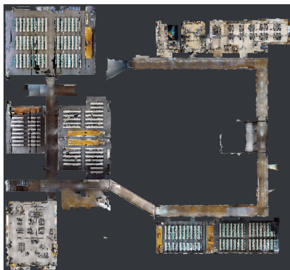
図 3 工学部 2 号館の点群データ。閉路の始点と終点の位置がずれている。
