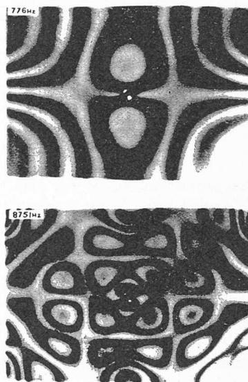
Fig. 12. — Franges de moiré donnant les courbes d'égale pente  $\frac{\partial w}{\partial x}$  pour les fréquences de 776 Hz et 8751 Hz.
