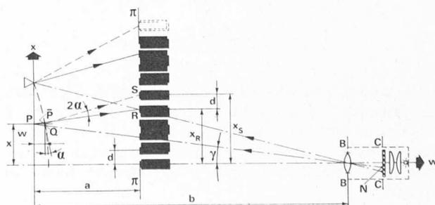
Fig. 2. — Principe de formation des franges.
