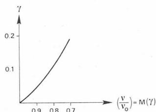
Fig. 5. — Variation du contraste en fonction du rapport  $\frac{v}{v_0}$  et pour  $\Omega \leq \frac{\lambda}{4}$ .
