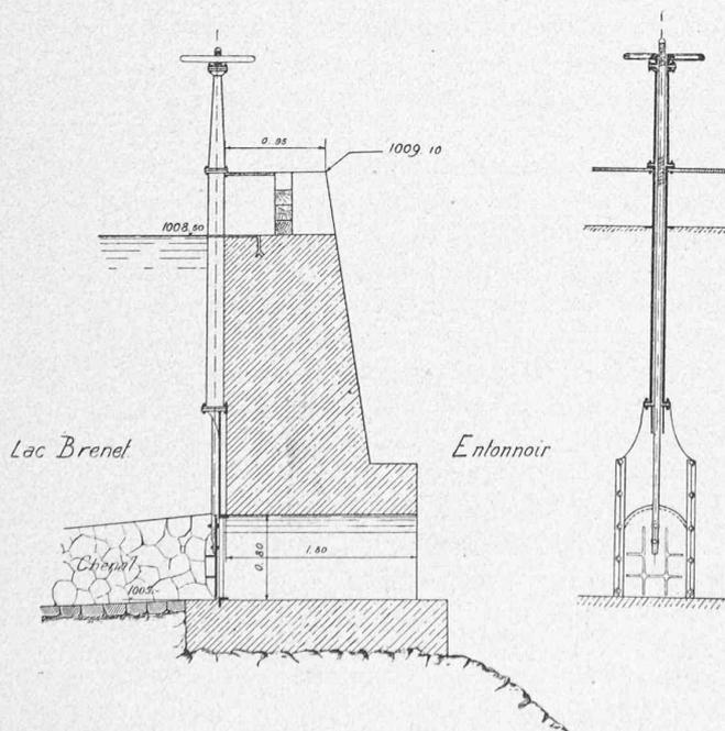
Fig. 7. — Coupe en travers d'un barrage des entonnoirs.
