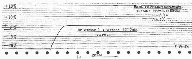
Fig. 7. — Mise en marche avec réglage automatique.
