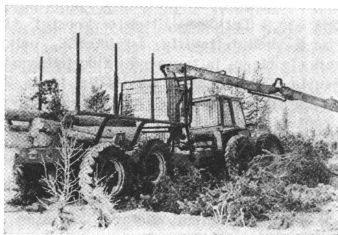
Kuva n:o 2. Kuljettajaan kohdistuva tarpeeton heilunta on pyrittävä poistamaan koneen tarkoituksenmukaisella suunnittelulla. Kun kuormain on sijoitettu koneen takarunkoon, ei ohjaamo heilu tarpeettomasti kuormauksen aikana. Tämä koskee erikoisesti monitoimikoneita.
